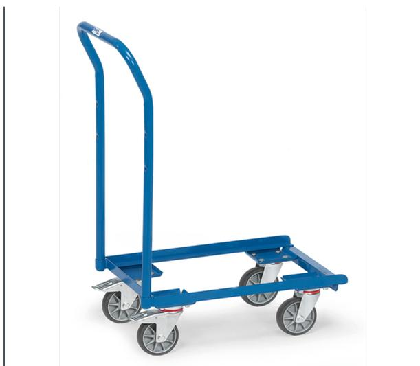
Construction en profilé d'acier, revêtement époxy bleu RAL 5007. Rouleur à armature ouverte avec rebord sur 3 côtés et dossier de poussée en tube d'acier. 4 roues pivotantes à bandage TPE, moyeu à roulement à billes central. 2 roues avec freins conformément à la Norme EN 1757-3. Compatible pour bacs plastiques 600 x 400 mm.
