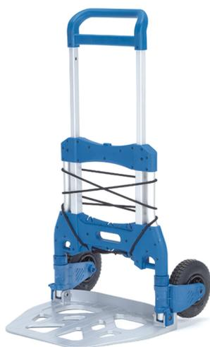
Fabrication de grande qualité en tube d'aluminium avec bavette en aluminium et parties en plastique de première qualité. Poignée de sécurité en plastique agréable au toucher. Sandow pour sécuriser les charges. Mise en place des roues et bavettes en quelques secondes. Roues gonflables 220 x 70 mm. Dimensions replié (h x l x p mm) : 855 x 660 x 135 mm.
