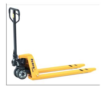
Châssis et fourches en tôle d'acier, revêtement époxy jaune. Pompe hydraulique manuelle, sans entretien. Poignée habillée de caoutchouc pour : lever - rouler - descendre. Modèle abaissé d'une hauteur de 55 mm levée 55 - 175 mm, pour charge à partir de 57 mm du sol. Roues directrices à bandage caoutchouc Ø 180 x 50 mm, boggies en nylon Ø 51 x 70 mm.
