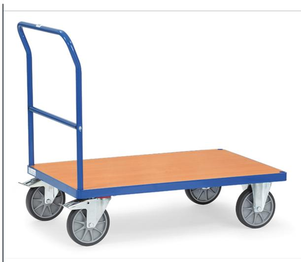
Système modulaire. Ensemble mécano-soudé, revêtement époxy bleu RAL 5007, plateau en mélaminé surface effet hêtre. 2 roues pivotantes et 2 roues fixes à bandage TPE, moyeu à roulement à billes central. Freins sur roues pivotantes conformément à la Norme 1757-3 (Sécurité des chariots de manutention).
