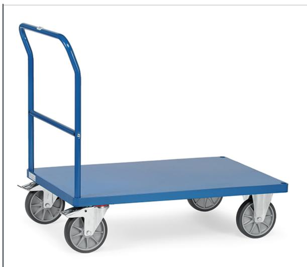
Système modulaire. Ensemble mécano-soudé, revêtement époxy bleu RAL 5007, plateau en tôle d'acier soudé de niveau dans l'armature. 2 roues pivotantes et 2 roues fixes à bandage TPE, moyeu à roulement à billes central. Freins sur roues pivotantes conformément à la Norme 1757-3 (Sécurité des chariots de manutention).
