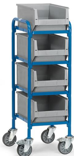
Ensemble mécano-soudé, revêtement époxy bleu RAL 5007. 4 plateaux en mélaminé surface effet hêtre avec rebord de 10 mm et 4 bacs (L x l x H : 500/450 x 310 x 200 mm). 4 roues pivotantes à bandage TPE, moyeu à roulement à billes. 2 roues avec freins conformément à la Norme EN 1757-3. Charge par plateau : 60 kg.
