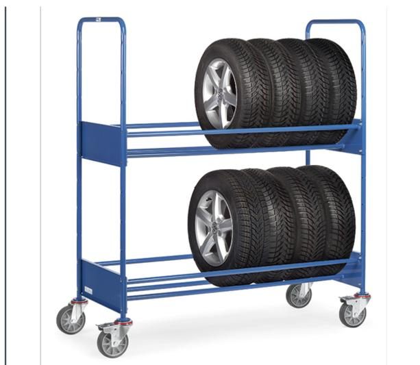
Construction en tube d'acier, revêtement époxy bleu RAL 5007. Supports de pneumatiques réglable au pas de 150 mm avec ridelle en tôle d'acier. 4 roues pivotantes à bandage TPE 160 x 40 mm, moyeu à roulement à billes central. 2 roues avec freins conformément à la Norme EN 1757-3 (Sécurité des chariots de manutention).
