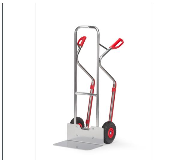
Ensemble mécano-soudé en aluminium. Soigneusement soudé sans revêtement, léger et maniable. Poignées de sécurité en plastique dur et patins amovibles. Tablier cintré permettant d'embarquer des éléments ronds tels que rouleaux, bidons, seaux etc. Bavette en tôle d'alu à boulonner et remplaçable. Roues en mousse polyuréthane increvables, moyeu à roulement à rouleaux. Livré avec bavette démontée.
