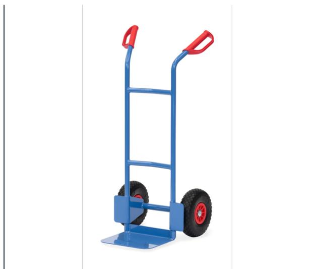
Ensemble mécano-soudé en tube et tôle d'acier, revêtement époxy bleu RAL 5007. Poignées de sécurité en plastique dur avec arceaux de sécurité. Bavette en tôle d'acier à boulonner et remplaçable. Roues en mousse polyuréthane increvables, moyeu à roulement à rouleaux. Tablier cintré permettant d'embarquer des éléments ronds tels que rouleaux, bidons, seaux etc. Livré avec bavette démontée.
